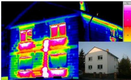
*Exemple d'image thermographique issue de l'utilisation d'une caméra thermique.*
